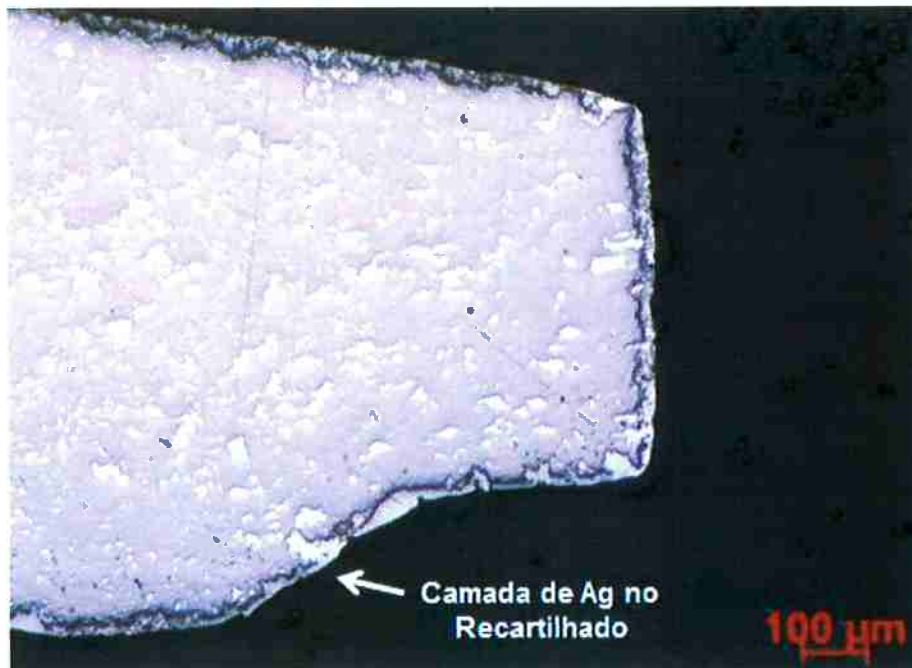
Figura 45 Micrografia mostrando em detalhe a camada obtida na superfície do recartilhado.
